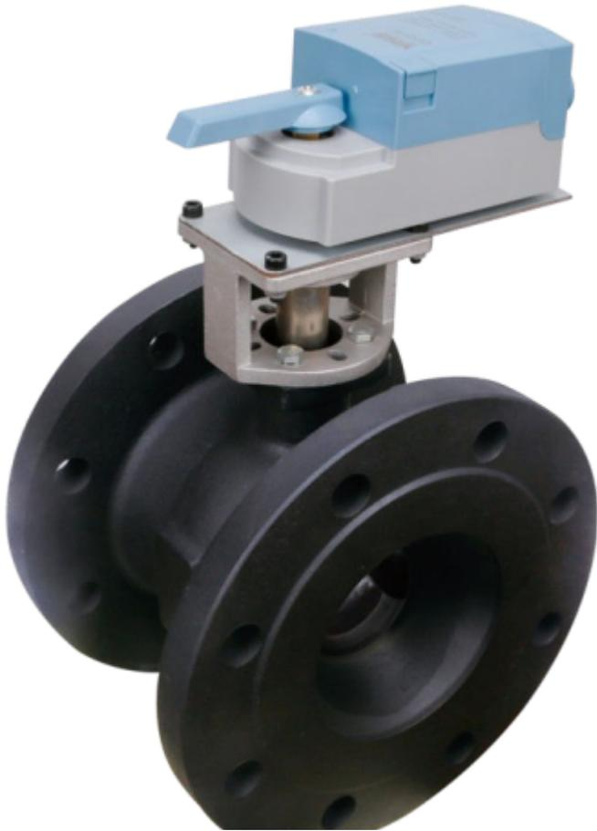
Шаровой кран с электроприводом серии DAV.A5 состоит из корпуса клапана из ковкого чугуна (DN65, DN80, DN100, DN125, DN150) и привод с большим крутящим моментом (от 16 Нм до 32 Нм), который может регулировать поток горячей / охлажденной воды в...
