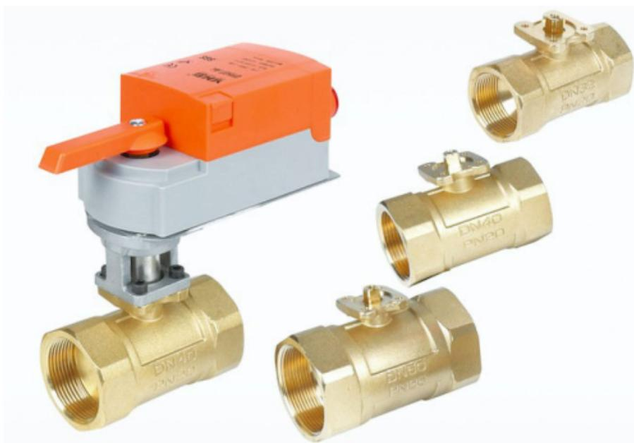
Шаровой кран с электроприводом серии А4 состоит из кованого латунного корпуса клапана (DN32. DN40. DN50) и большого крутящего момента привод (от 8 Нм до 24 Нм), который может регулировать поток горячей/охлажденной воды в трубе, широко...
