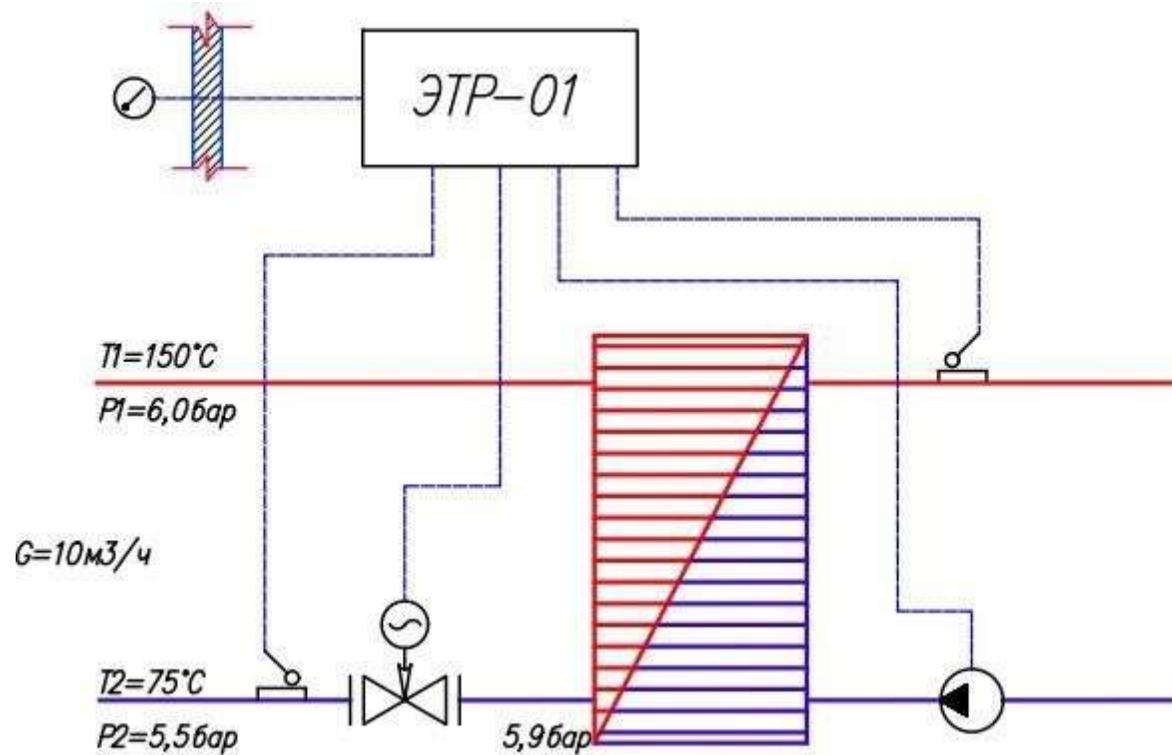
1. Определяем требуемую пропускную способность клапана:
