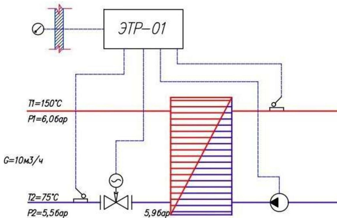
1. Определяем требуемую пропускную способность клапана:
