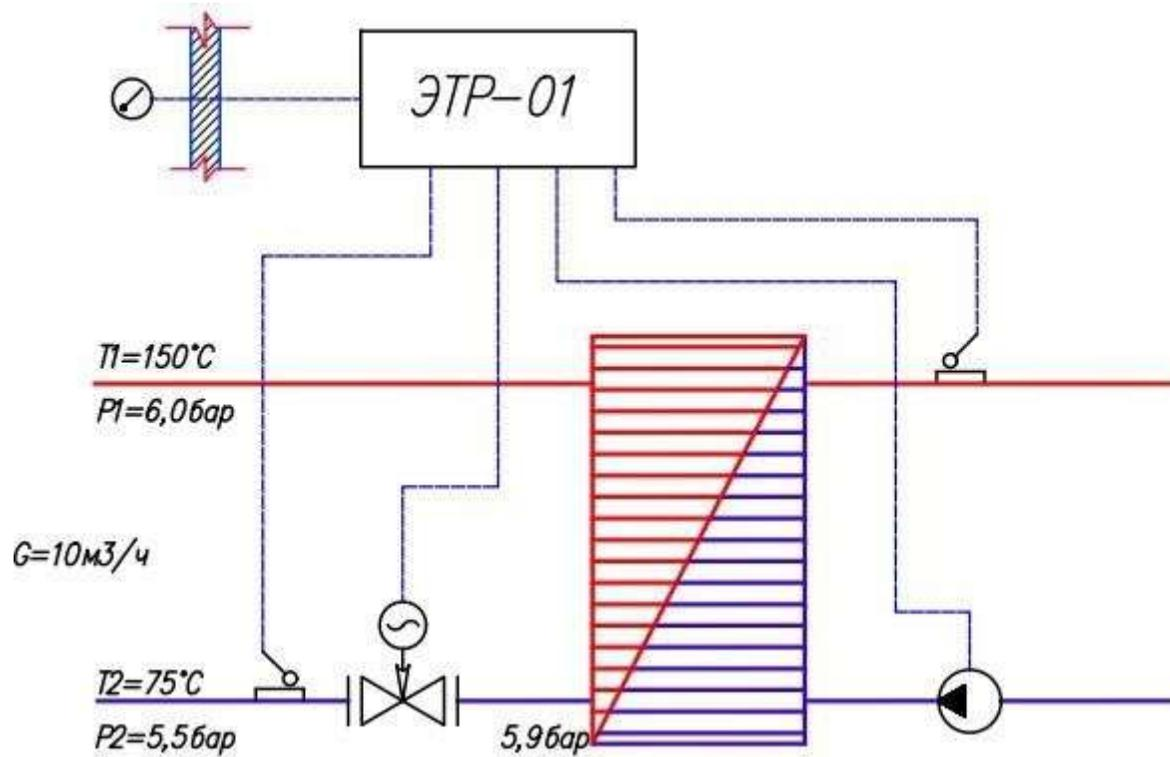
1. Определяем требуемую пропускную способность клапана:
