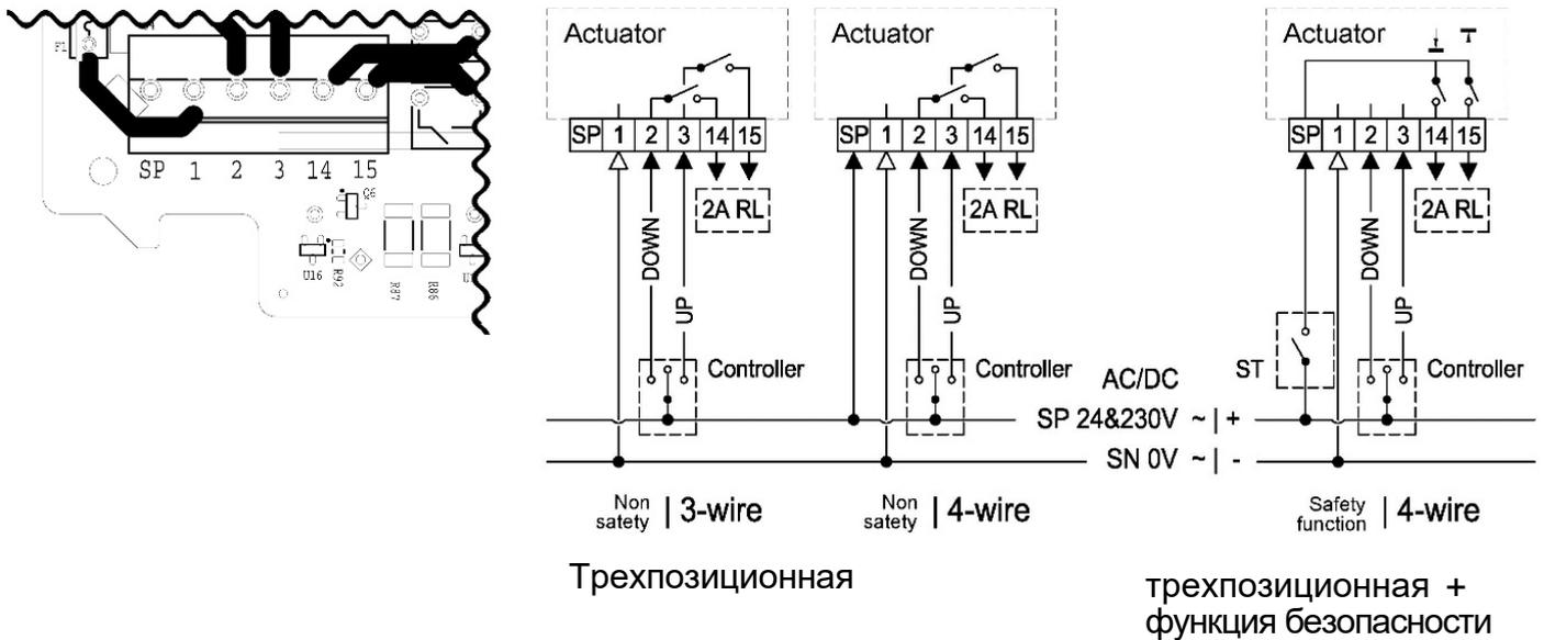
**Клеммы 2:** Подача импульсного сигнала от регулятора - движение штока вниз.
